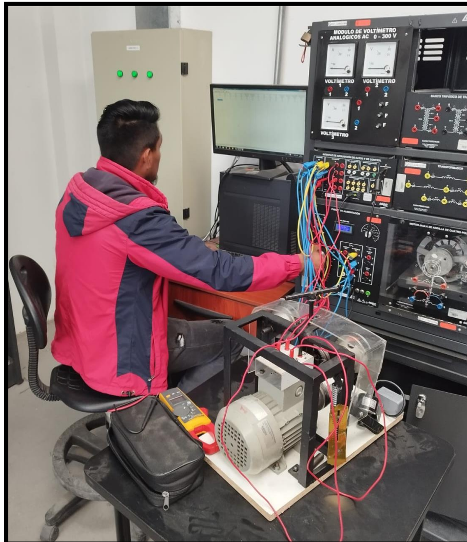
Anexo 3. Conexión del motor con rotor bloqueado y conexión con la interfaz de datos.
