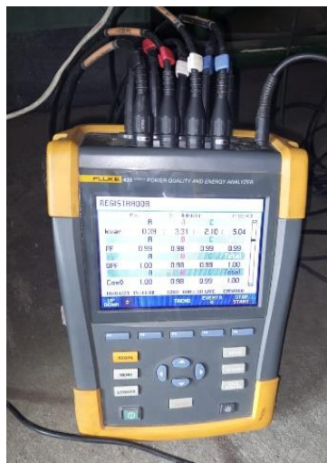
Figura 4.2. Equipo de medición analizador de redes.
