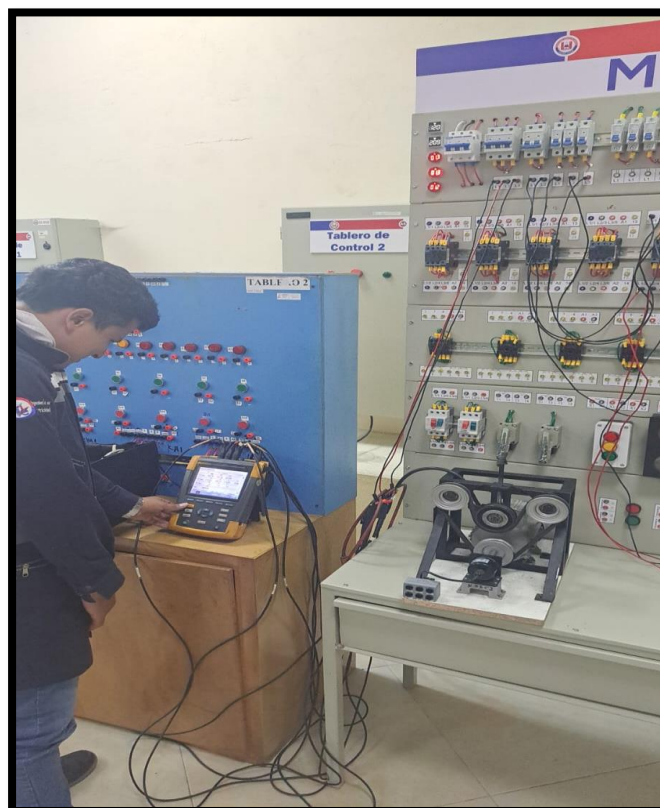
Anexo 2. Conexión directa del motor en configuración estrella en vacío y uso del analizador de redes.
