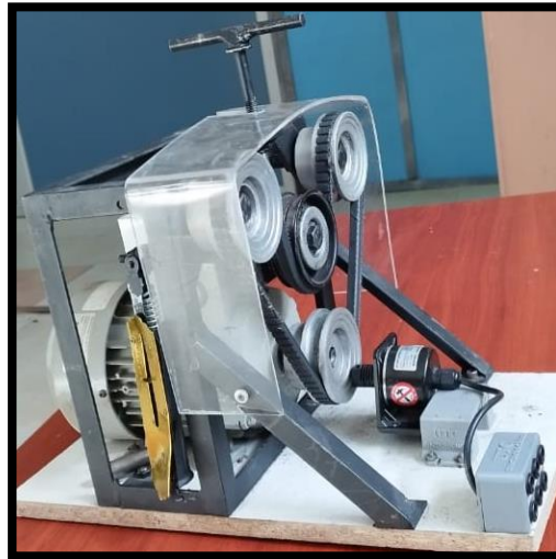
Anexo 3. Conexión del motor con rotor bloqueado y conexión con la interfaz de datos.
