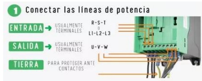
Figura 4. Conexión de las líneas de alimentación.
