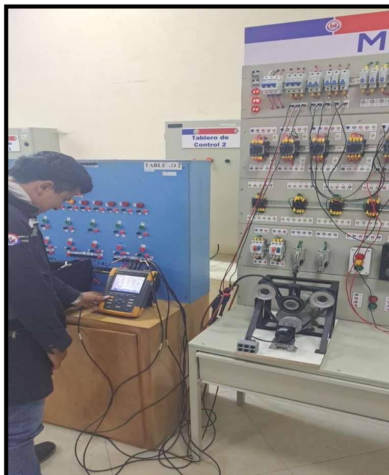
Anexo 2. Conexión del analizador de redes al motor trifásico jaula de ardilla de 1hp.
