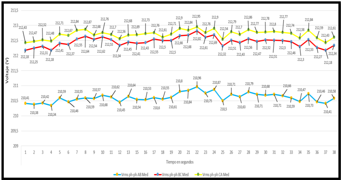
Figura 5.11. Voltaje de arranque directo con carga (20Kg).
