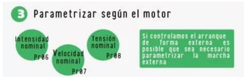
Figura 6. Parámetros del motor.
