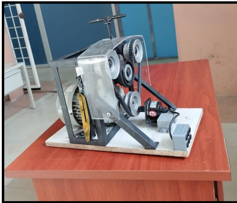
Anexo 2. Conexión directa del motor en configuración estrella en vacío y uso del analizador de redes.
