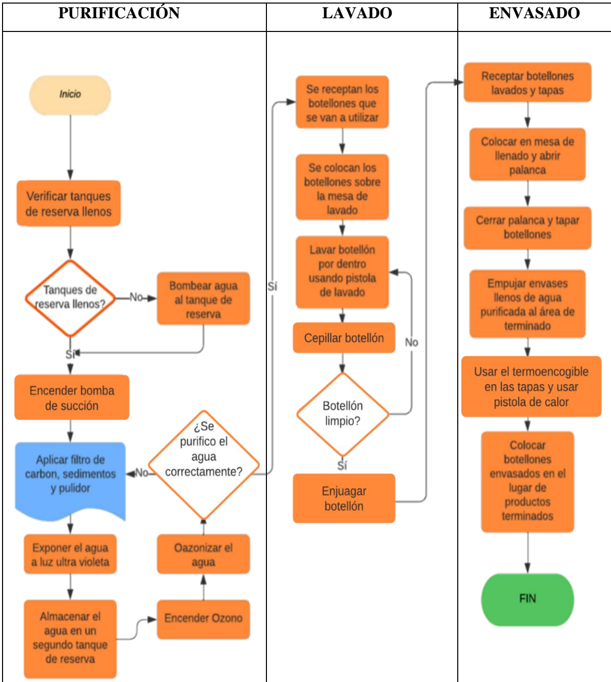
Figura 7. Flujoograma del proceso de Producción
