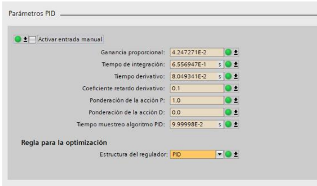
Figura 32. Valores óptimos del control PID obtenidas mediante PID_Compact Estructura para la implementación de un PID
