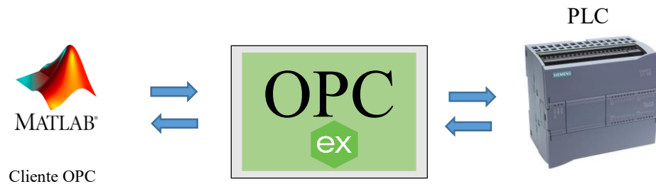
Figura 16. Estructura de comunicación utilizando un OPC server [25]
