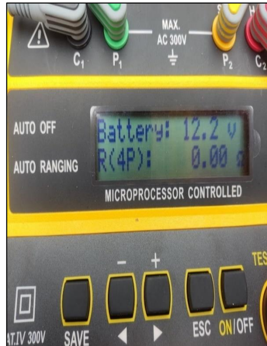
Figura 38. Lectura de resistividad con aditivos / Lectura de resistencia con aditivos
