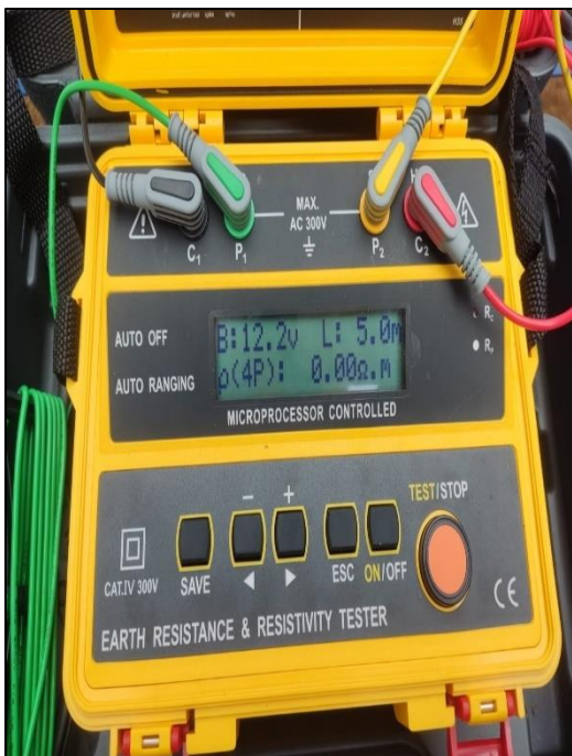
Figura 38. Lectura de resistividad con aditivos / Lectura de resistencia con aditivos
