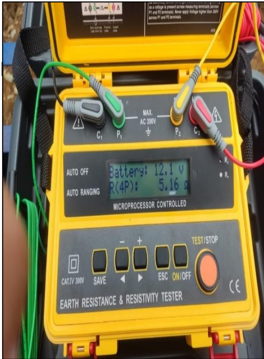
Figura 35. Lectura del Telurómetro / Toma de lecturas en el terreno
