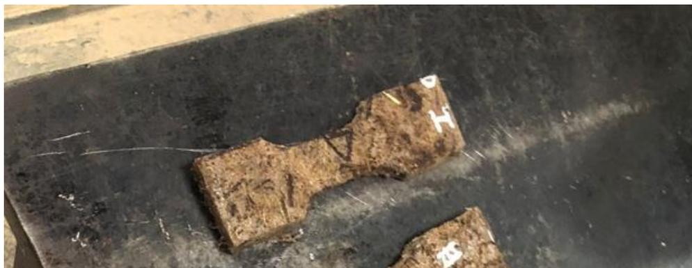
Figura 3.3. Prototipo de probeta Sheet Type de la norma ASME E8.
