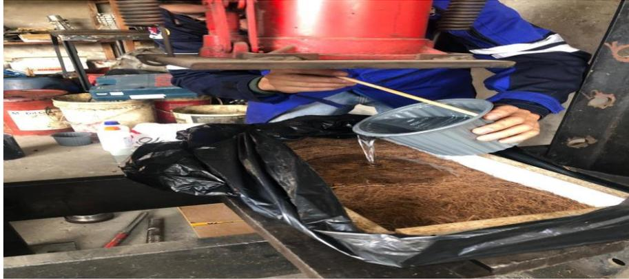
Figura 3.10. Vertido del mezclado de resina en los moldes
