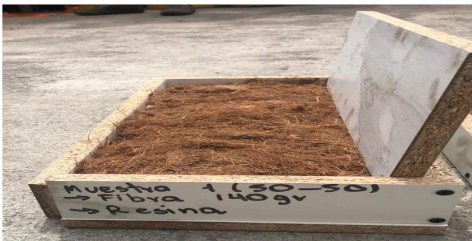
Figura 3.7. Relleno de molde de estopa con resina (50-50)
