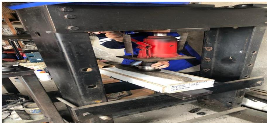
Figura 3.11. Aplicación de fuerza hidráulica sobre los moldes
