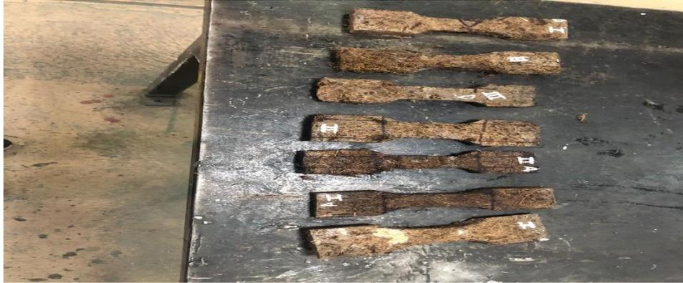
Figura 3.16. Corte de probetas
