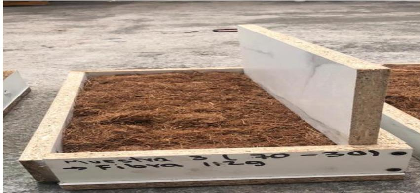
Figura 3.8. Relleno de molde de estopa con resina (70-30)
