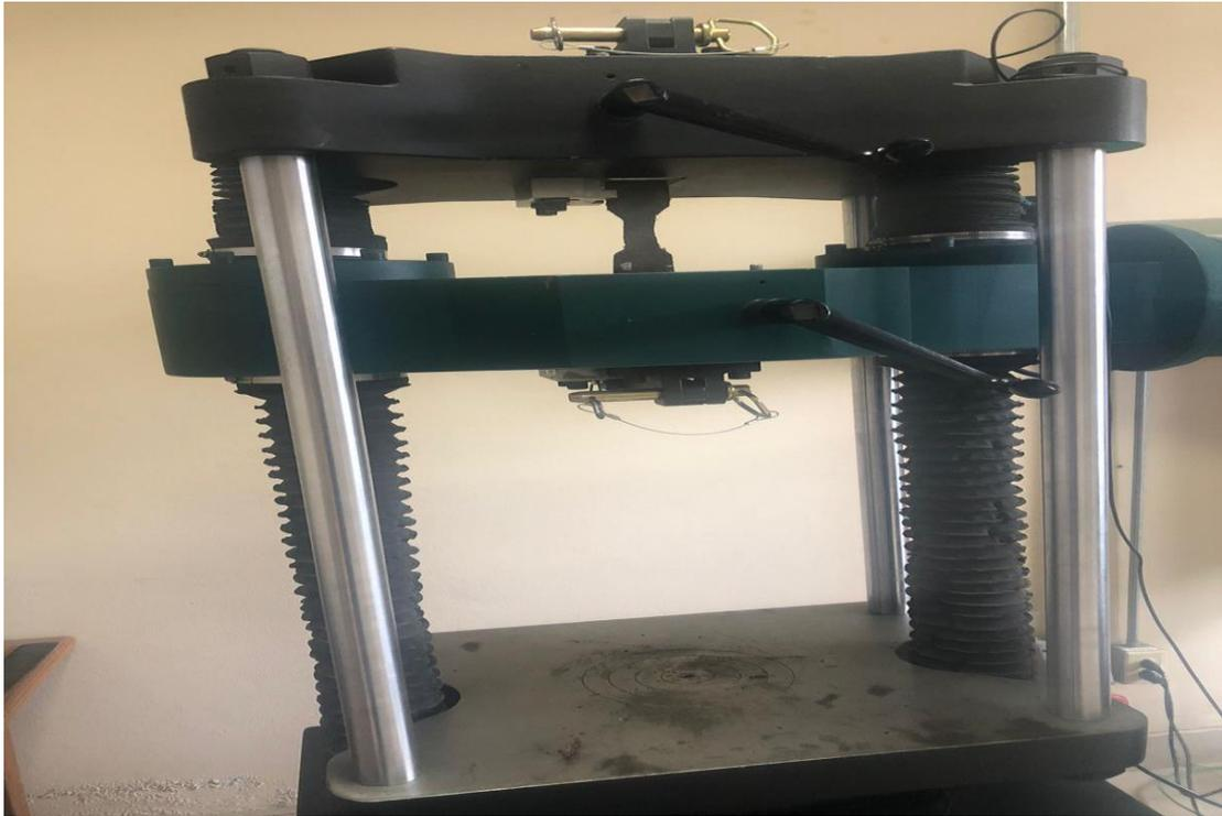
Figura 3.20. Ajuste de probetas para el ensayo de tracción
