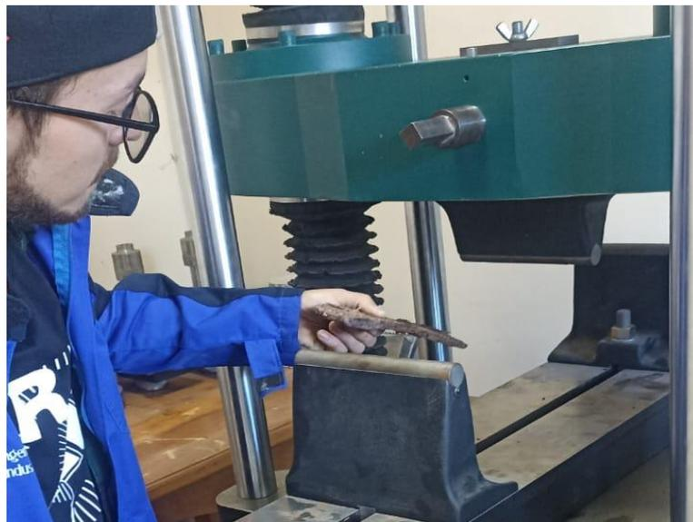
Figura 3.17. Colocación de probetas en máquina de ensayos de flexión
