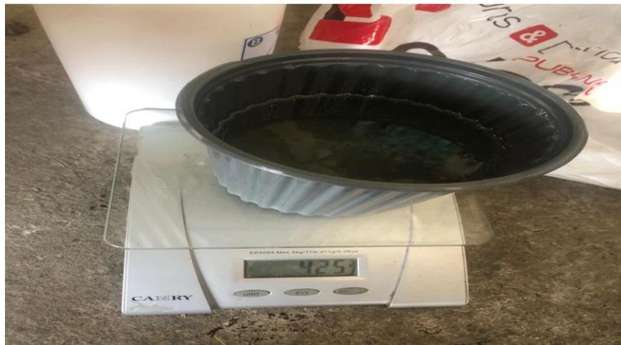
Figura 3.9. Mezclado de los elementos de resina a 50-50
