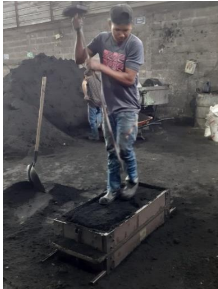
Figura 3.9: Conformado de molde con arena de relleno.
