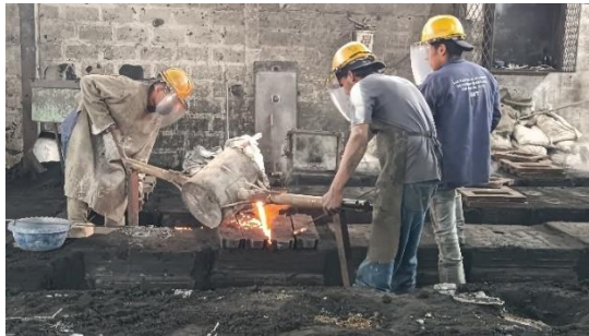
Figura 3.11: Colado de material fundido.
