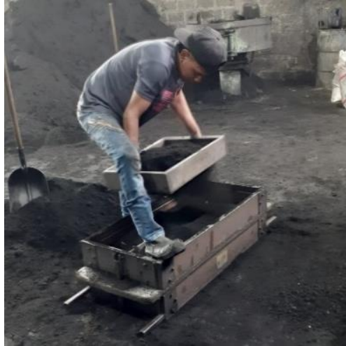
Figura 3.8: Conformado de molde con arena de contacto.
