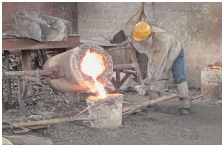
Figura 3.31: Vaciado de material fundido a cuchara.
