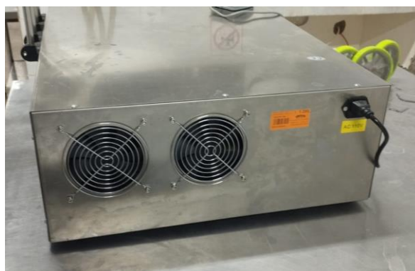
Ilustración 10 Ventiladores de ingreso y de corriente
