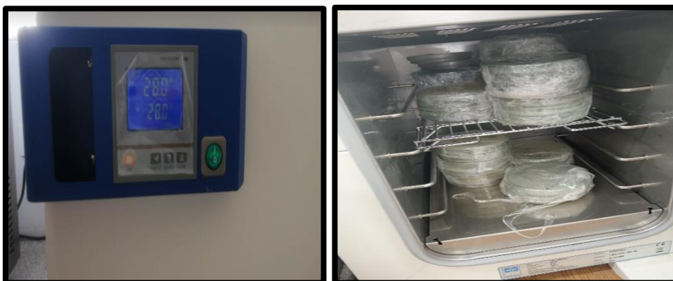
Figura 18: Incubación de Metarhizium en equipo Rebelk modelo R1-50, a 28 °C por un período de 7 días.
