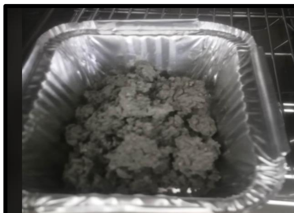
Figura 26: Secado del sustrato en la incubadora a 28 °C, en 3 días
