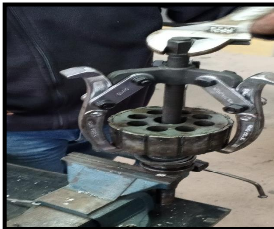
Figura 5.21. Extractor mecánico sujeto al rotor
