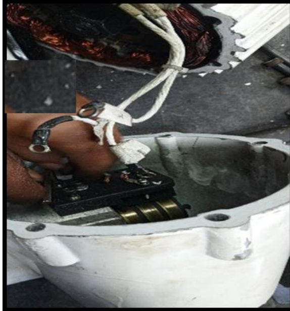
Figura 5.35. Conexión de estator al generador de energía alterna
