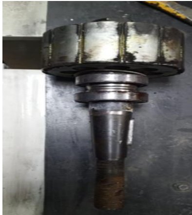
Figura 4.3. Generador con problema de corto circuito.
