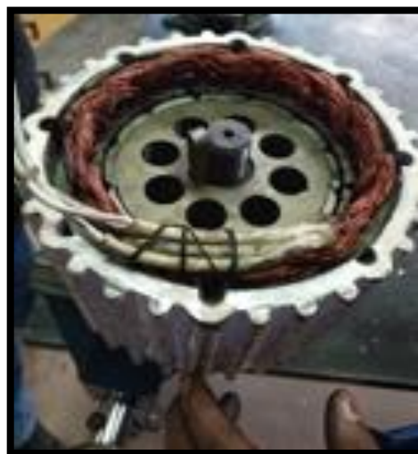
Figura 5.34. Colocación de rotor en estator
