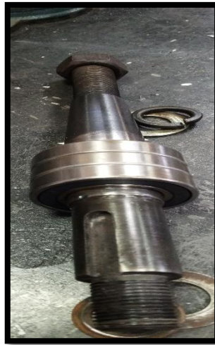
Figura 5.32. Eje con nuevos rodamientos
