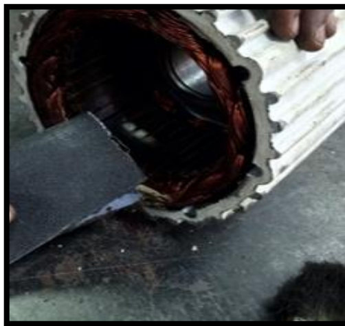
Figura 5.33. Limpieza de estator
