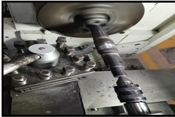
Figura 5.28. Eje en proceso de torneado
