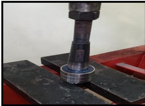
Figura 5.31. Eje rectificado en prensa mecánica
