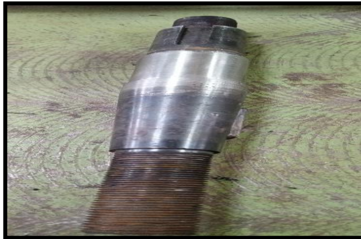
Figura 5.30. Eje después del proceso de torneado y rectificación
