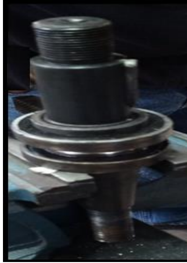
Figura 5.22. Eje de rotor con rodamientos desgastados
