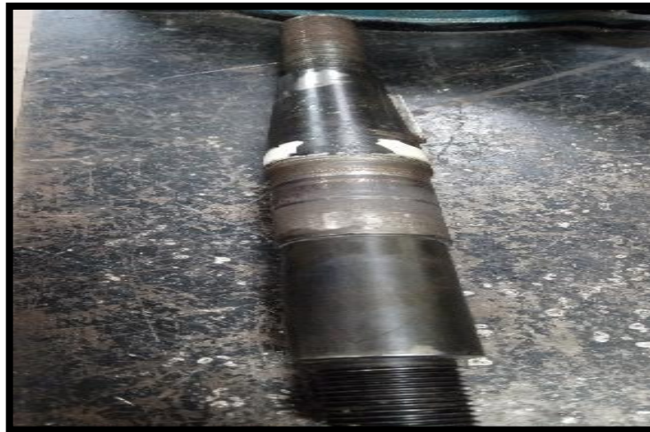
Figura 5.24. Eje de rotor desgastado
