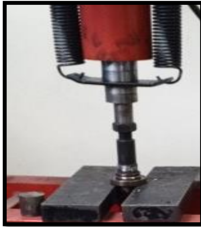
Figura 5.23. Eje de rotor con rodamientos sujeto a prensa mecánica
