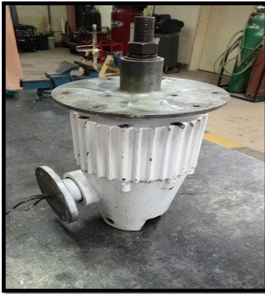
Figura 5.38. Generador realizado las correcciones y mantenimiento
