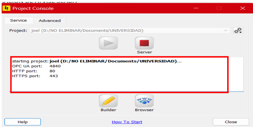
Figura 4.10. Puertos de comunicación de atvise SCADA
