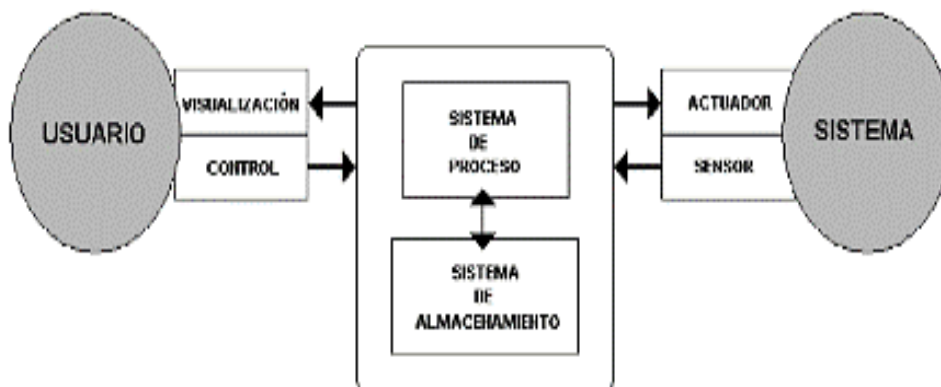
Figura 2.2 arquitectura general de un sistema SCADA [5]
