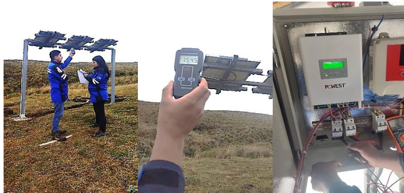
Figura 4.14. Recolección de datos con el pirómetro y multímetro.
