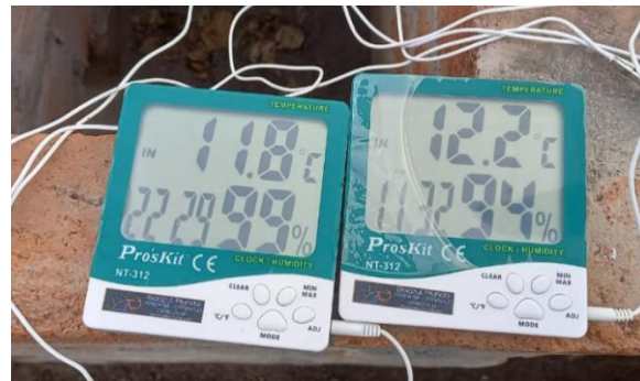
Fotografía 4: Termómetro de temperatura y humedad.
