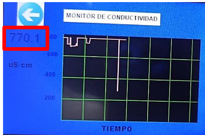
Figura 3.23. Visualización del valor de conductividad eléctrica con el instrumento implementado.
