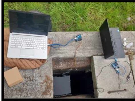
Figura 3.10. Colocación del sensor pH para obtener datos.
