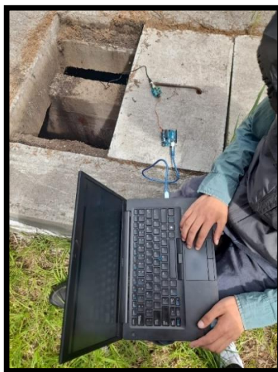
Figura 3.15. Colocación del sensor de oxígeno disuelto para obtener datos.
