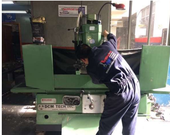
Figura 3.13: Rectificación de superficies planas
