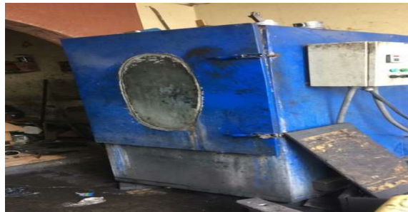
Figura 3.7: Lavado del motor
