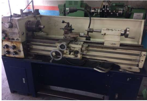
Figura 3.10: Corte de camisas en torno
