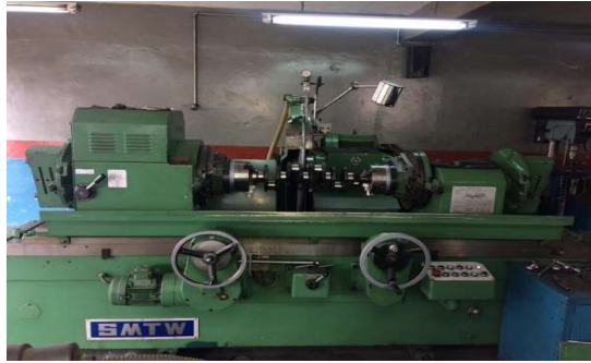
Figura 3.8: Reactivación de cigüeñales
