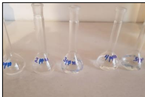
Gráfico 28: Preparación de la curva de calibración
