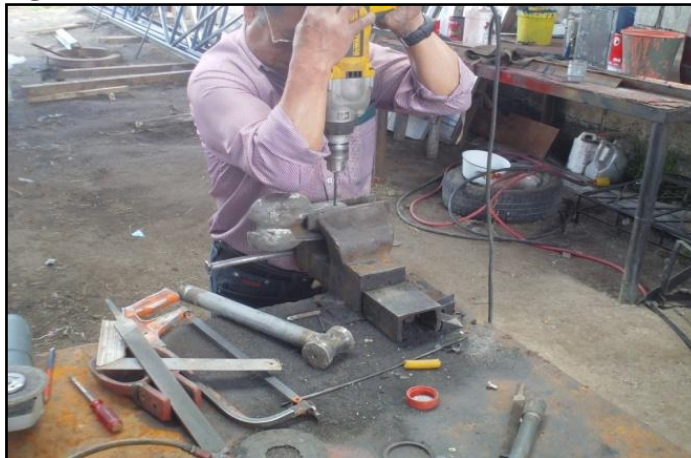
Figura: 3.30 PERFORACIÓN DE CUCHARINES.
