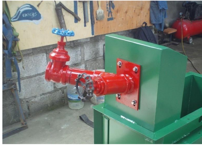
FIGURA: 3.38 CONJUNTO INYECTOR Y SISTEMA DE REGULACIÓN.
