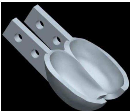
Figura: 3.27 Cucharin Pelton modelo
