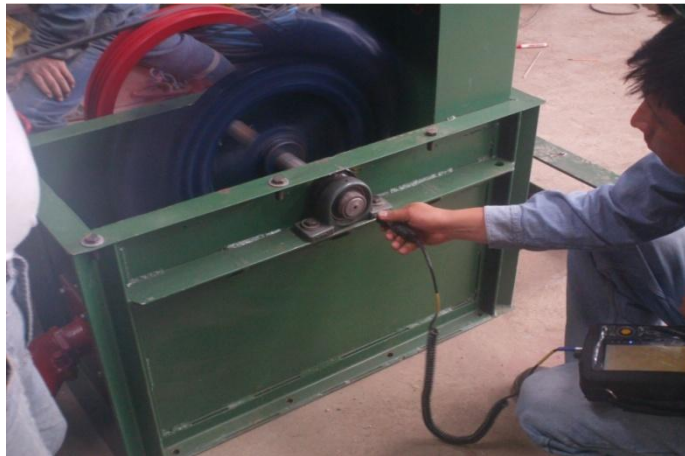
Figura: 3.36 COMPROBACIÓN DE BALANCEO DINÁMICO DE RUEDA PELTON.
