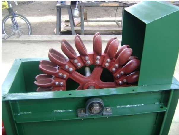
Figura: 3.32 ACOPLAMIENTO DE RODETE Y CHUMACERAS.
