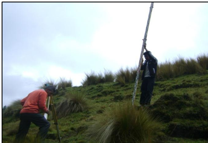
Figura 2.3 MEDIDA DE LA ALTURA BRUTA USANDO LA ESTACIÓN TOPOGRÁFICA.
