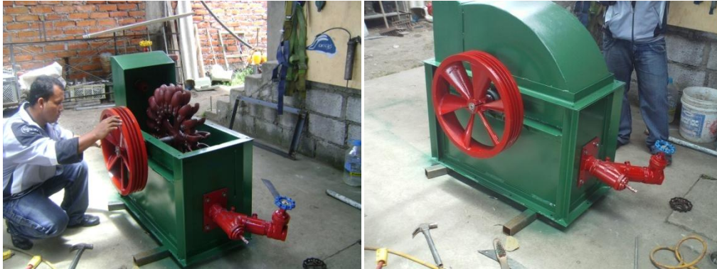
Figura: 3.34 ACOPLAMIENTO DEL SISTEMA DE TRANSMISIÓN.
