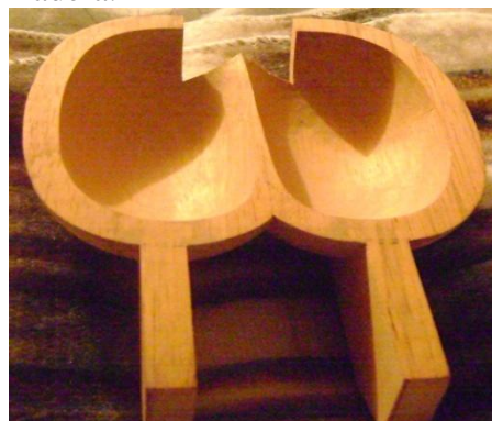
Figura: 3.28 Cucharin Pelton molde madera.
