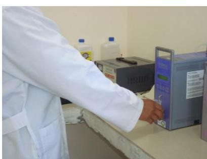
Este analizador de leche realiza análisis fisicoquímico de la leche. El analizador de leche EKOMILK succiona una pequeña muestra de leche y la somete al paso de una onda de ultrasonido. Un microprocesador traduce los resultados midiendo los siguientes parámetros:
