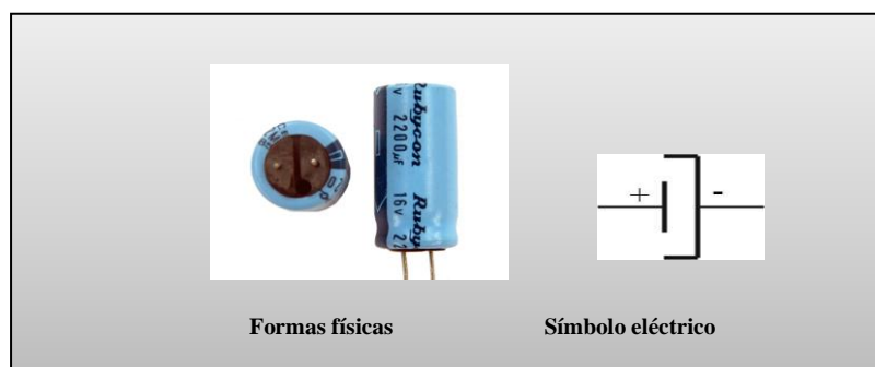
FIGURA 1.2 FORMA FÍSICA Y SÍMBOLO DEL CAPACITOR ELECTROLÍTICO.
