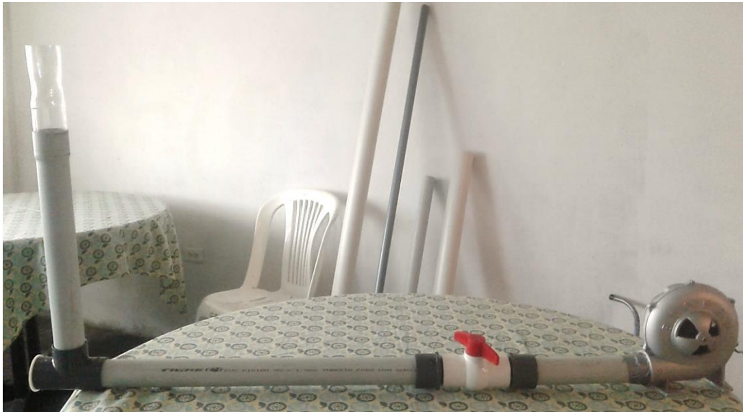
Figura 24. Instalación experimental para la velocidad de flotación
