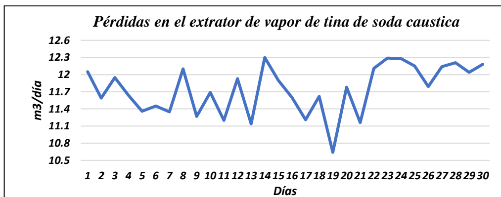
Figura 64: Caudales en extractor de vapor de soda, con aforamientos volumétricos.
