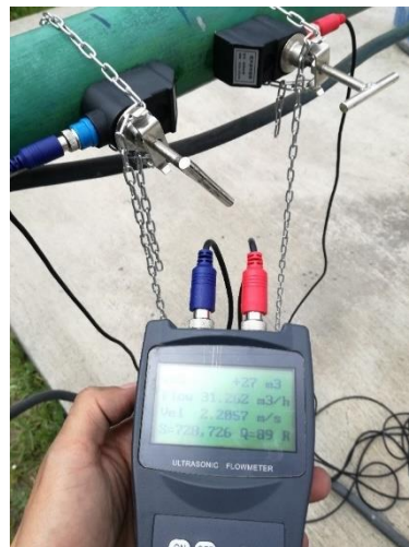
Figura 174: Medidor de caudal ultrasónico TDS-100H, medición en tuberías cerradas.
