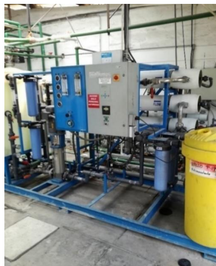
Figura 104: Sistema de ósmosis inversa grande.
