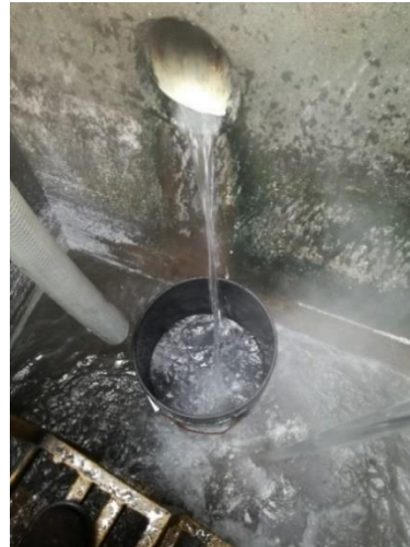
Figura 173: Aforamiento volumétrico para sistemas de tuberías abiertas.
