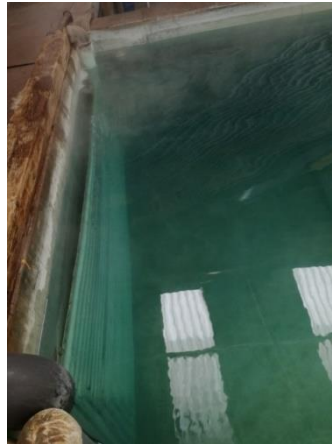
Figura 138: Serpentín, calentamiento del agua en las tinas de anodizado.
