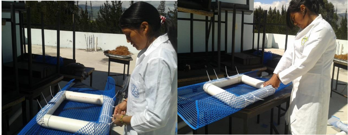
Colocación de la malla en la base de la isla flotante
