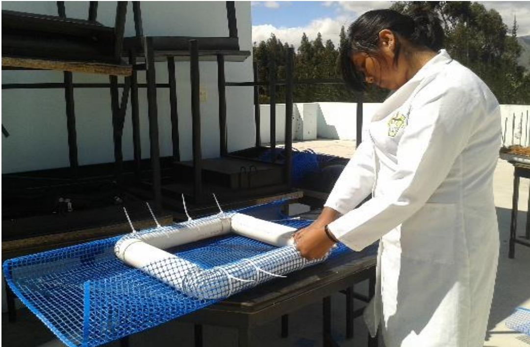
Figura 8: Ensamblado de la matriz flotante
