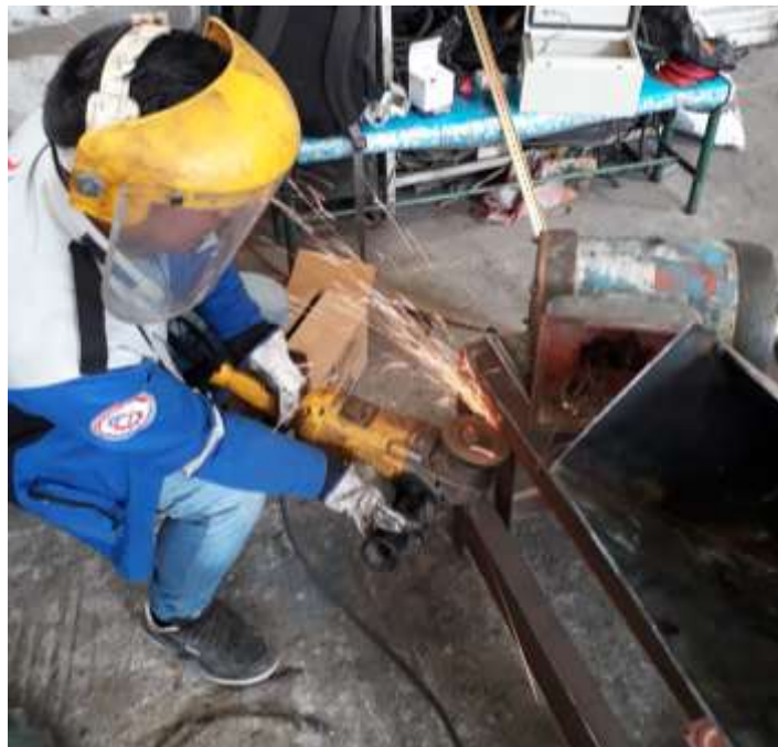
Pulido y ensamble de los elemento constitutivos de la trituradora.
