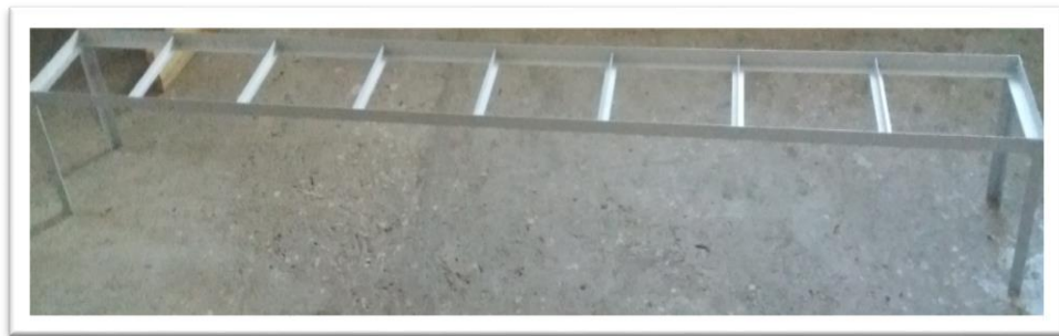
Figura 25: Soporte de aluminio de los lentes fresnel.
