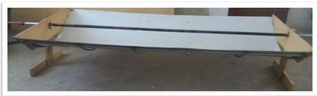
Figura 24: Concentrador solar parabólico.
