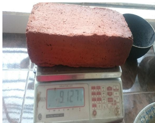
Anexo 19. Medición de ladrillos humedecidos
