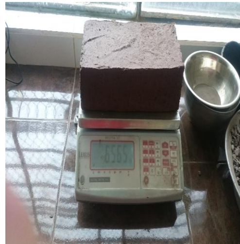
Anexo 14. Medición de humedad
