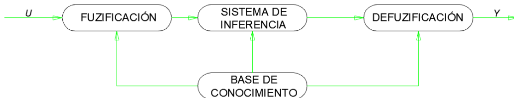
Figura 1.23. Estructura general de un controlador difuso (ADAPTADO DE: (García, y otros, 2017))
