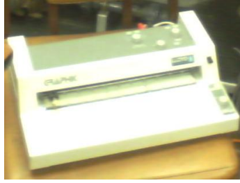
Figura 3.2. Registrador de datos de flujo, equipo integrable a la estación de flujo para el registro de datos.
