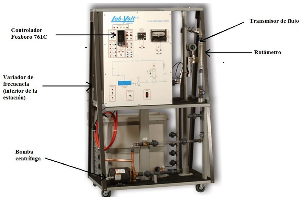
Figura 3.1. Componentes de la estación de flujo
