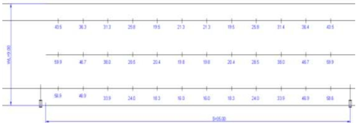
**Figura 3.27. Detalle mediciones de Iluminancia tramo P2132-P2131, Ing. Fabián Granja.**
