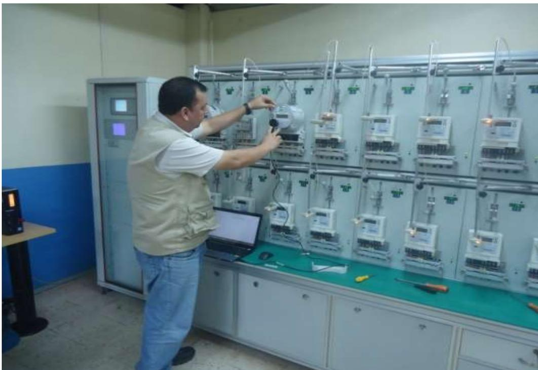
**Figura 3.10. Fotografía bajando datos medidor eléctrico KV2c, Ing. Fabián Granja.**
