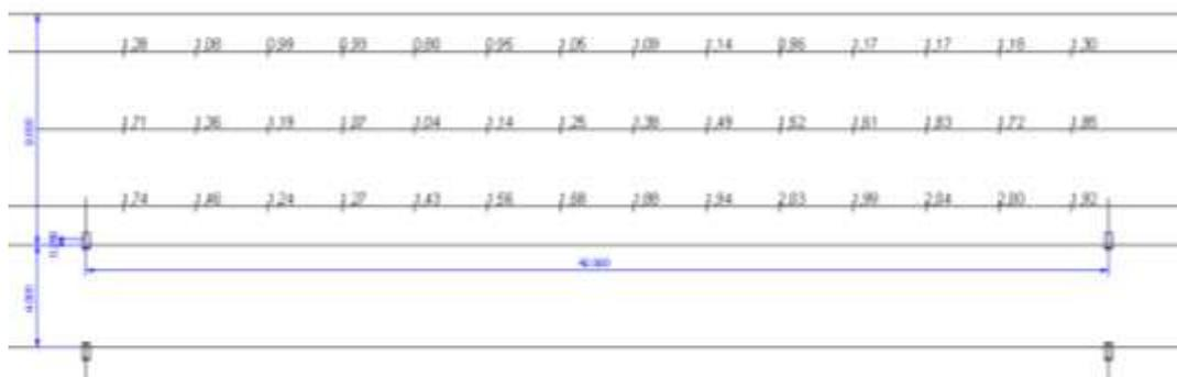
**Figura 3.33. Detalle mediciones de luminancia tramo P1410-P1411, Ing. Fabián Granja**
