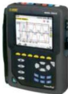
Figura 2.4.- Analizador de calidad de energía eléctrica Modelo 3945-B, (AEMC INSTRUMENTS, 2009)
