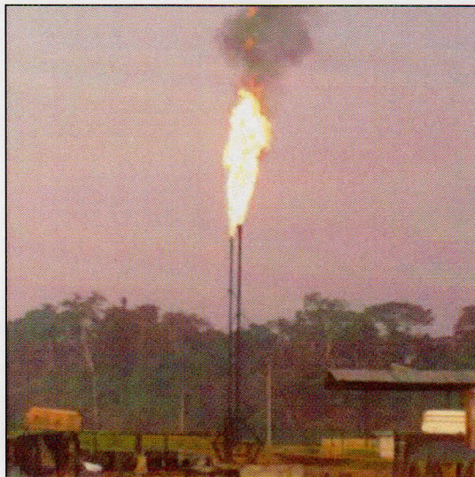
Figura 3.2. Vista de la combustión de los gases en el mechero de la plataforma.
