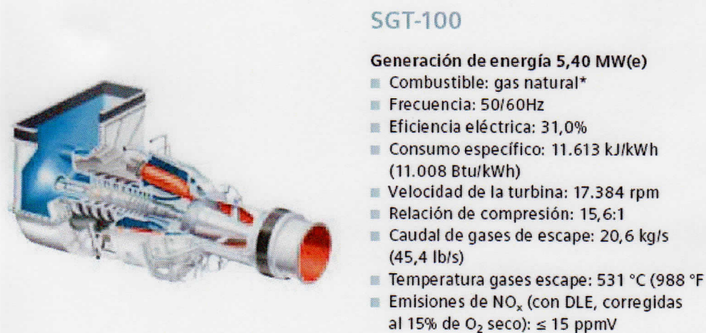
Figura 2.3. Características de la Turbina Siemens SGT-100 (Siemens, 2013)
