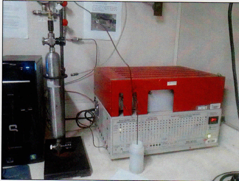
Figura 3.8. Equipo armado listo para iniciar cromatografía.
