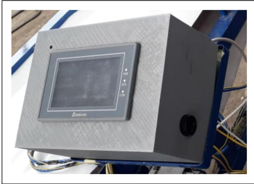
Figura 4. Ubicación del sensor de movimiento para la activación automática del sistema
