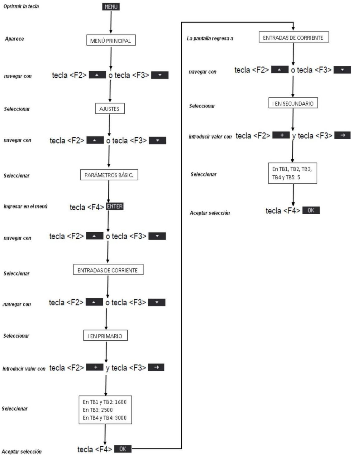
Para que el medidor inteligente quede configurado en forma modular, y si se desean aumentar más medidores al sistema de monitoreo eléctrico es necesario establecer una configuración de comunicación lógica, con el procedimiento de la figura 26.
