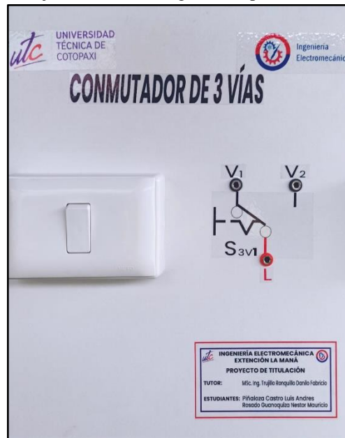
Figura 18: Instalación del conmutador de 3 vías junto a la simbología correspondiente.
