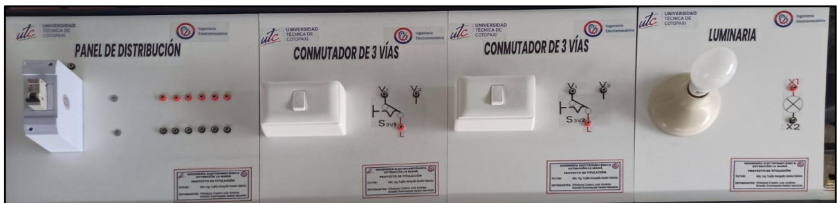
Figura 23: Colocación de las láminas didácticas, para la realización de la práctica a realizar, lámpara conmutada desde 2 puntos.
