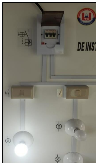
Figura 8: Encendido de una luminaria mediante un interruptor simple.
