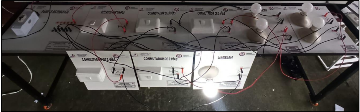
Figura 21: Circuito en escalera con conexiones implementadas en funcionamiento.
