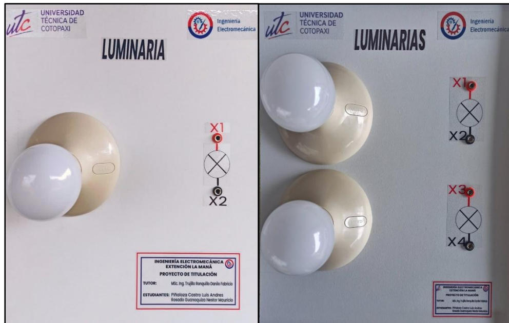
Figura 19: Fotografías donde se muestra la luminaria única y la luminaria doble, con su respectiva simbología en cada caso.
