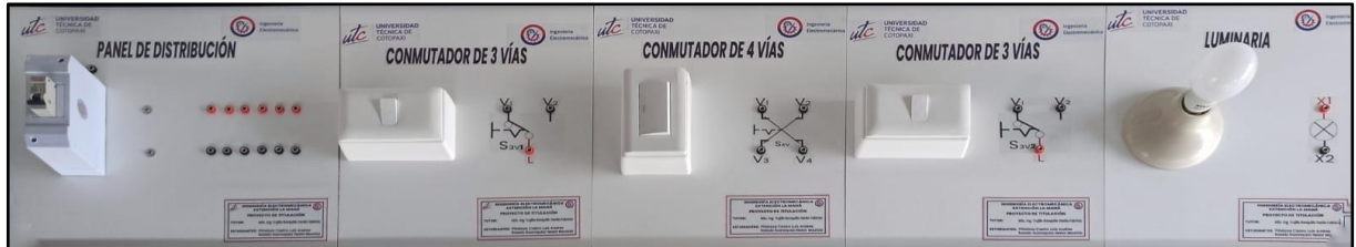
Figura 24: Colocación de las láminas didácticas, para la realización de la práctica a realizar, lampara conmutada desde 3 puntos.
