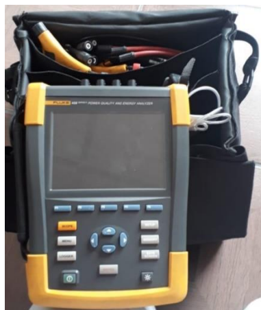
Figura 26. Analizador de red FLUKE 435-SII Fuente: Sandra Chasiluisa
