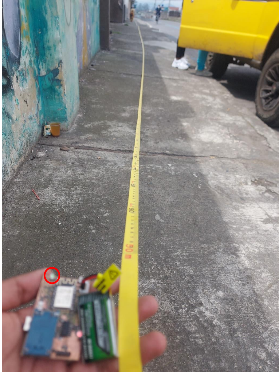
Figura 5.8. Prueba de recepción de señal Wi-Fi.
