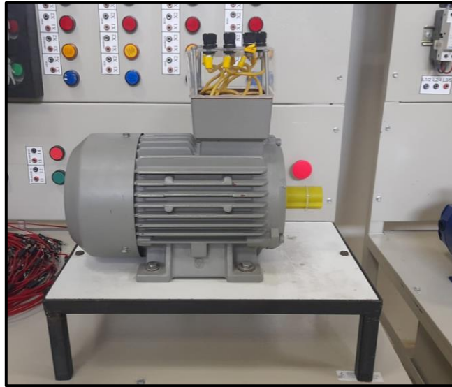
Anexo 2 Motor trifásico jaula de ardilla de 2hp
