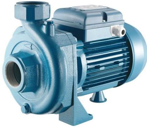
Pompe centrifughe di media portata per piccole e medie applicazioni agricole. Dotate di girante aperta per consentire il passaggio di piccoli corpi solidi (Ø max. 10 mm.).
