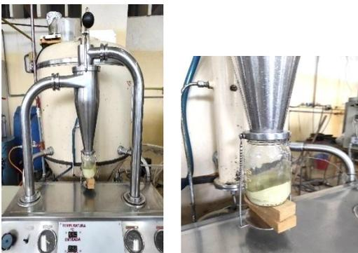
*Figura 22 Producto final del secado por aspersión*
