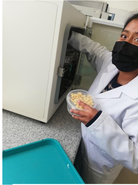
Someter a las semillas en una cámara de envejecimiento acelerado
