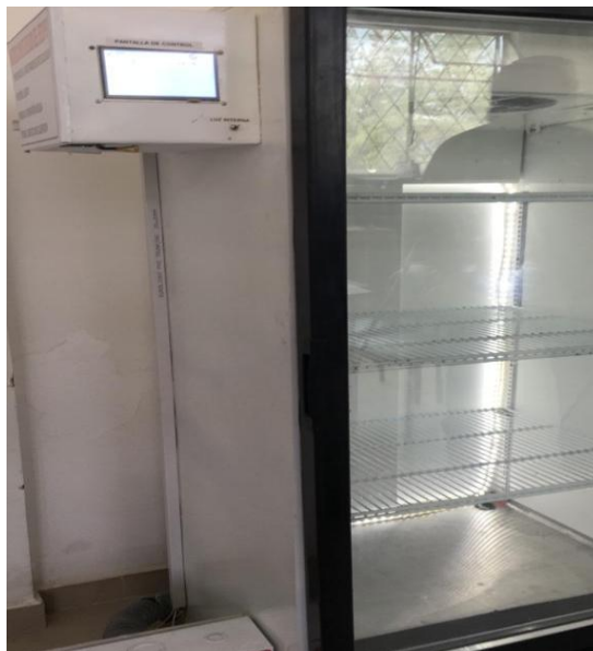
ANEXO 6.- Reconversión tecnológica de un refrigerador panorámico en una cámara de crecimiento e instalación en el laboratorio de entomología.
