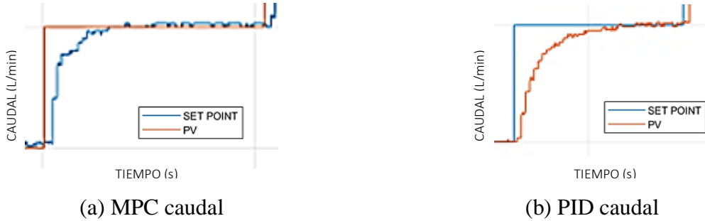
Figura 5.24. Comparación de los controladores MPC y PID a 30L/min
