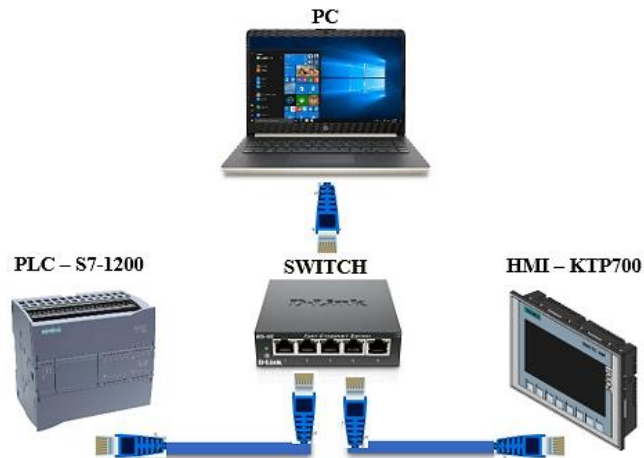
Figura 4.37. Estructura de conexión para el SCADA
