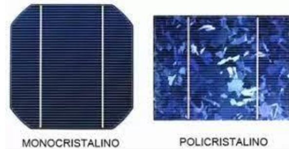
Figura 3.2 Células FV de silicio poli y monocristalino
