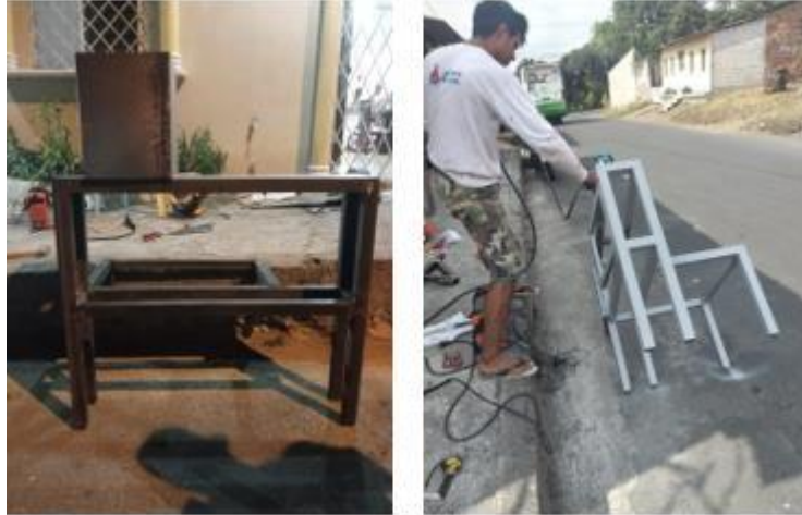
Figura 29 Pintada y armada de la máquina de desgaste abrasivo
