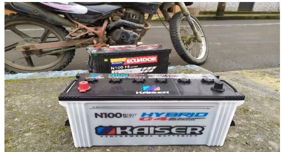
Foto 4. Cambio de batería marca Kaiser 12V
