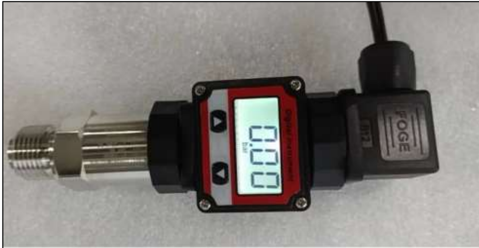
Imagen 17. Transmisor de Presión sin montar en la tubería
