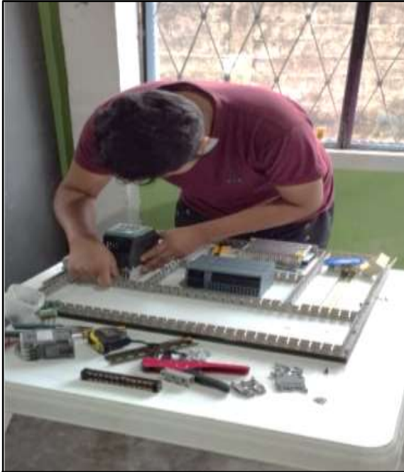
Fijación de canaletas y equipos a la placa de madera
