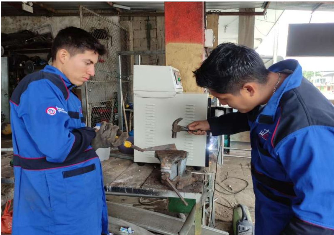
Foto 7: Acero realizando la prueba de resistencia extraído con un nivel de temperatura de 800° Celsius.
