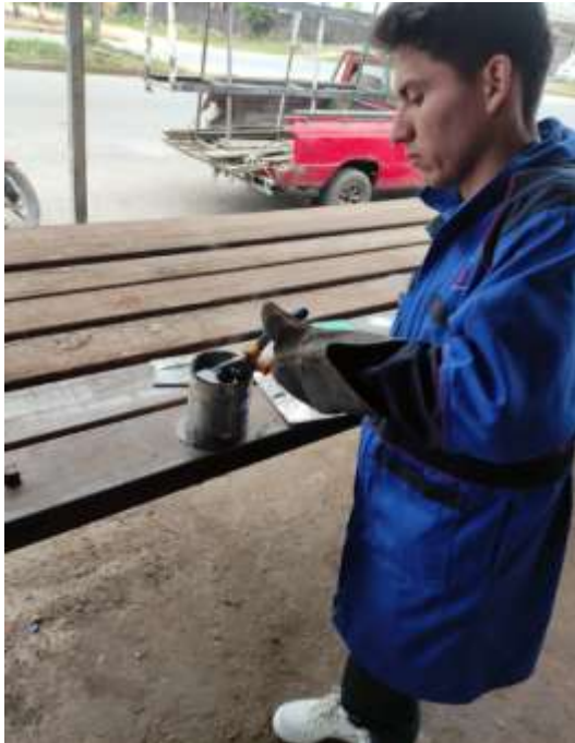
Foto 5: Enfriado el acero extraído de la mufla.
