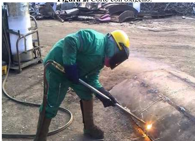
Figura 2. Corte con oxígeno.
