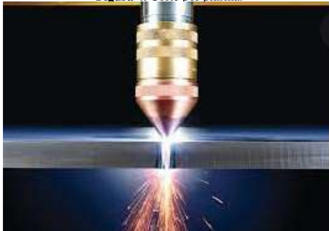
Figura 4. Corte por plasma.
