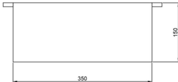
Figura 28 Dimensiones de la tina de enfriamiento
