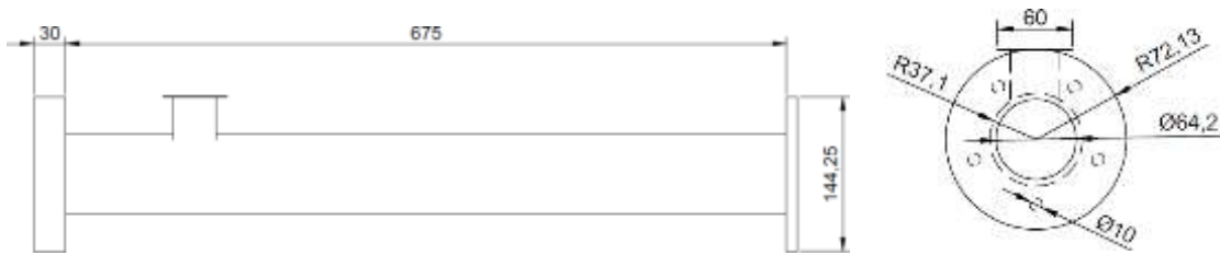
Figura 21 Diseño del cilindro extrusor
