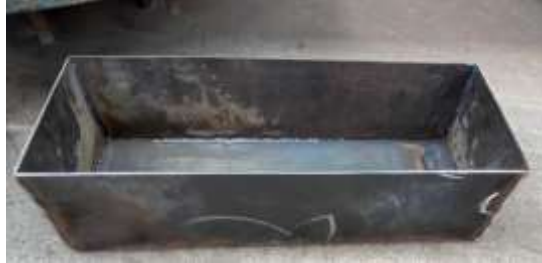
Figura 29 Fabricación de la tina de enfriamiento
