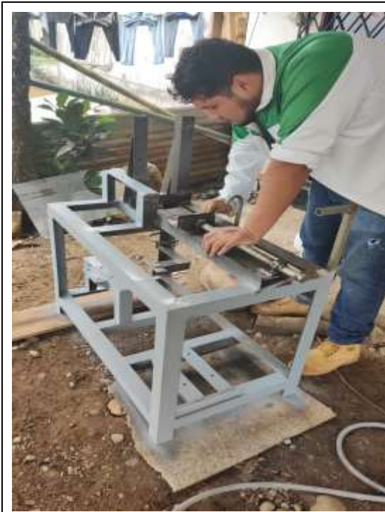
Fondeado de estructura
