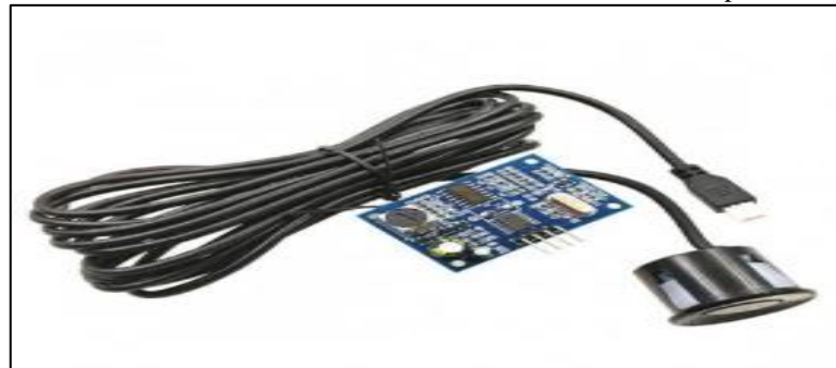
Ilustración 4: AJ-SR04M Sensor de distancia ultrasonido impermeable
