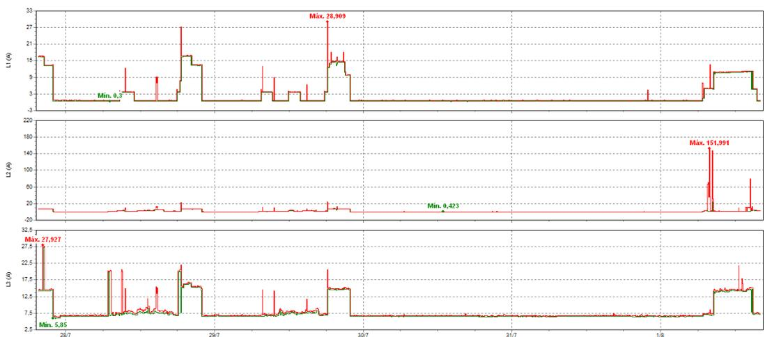
**Figura 25.** Niveles de corriente L1- L2- L3 en TDSG1
